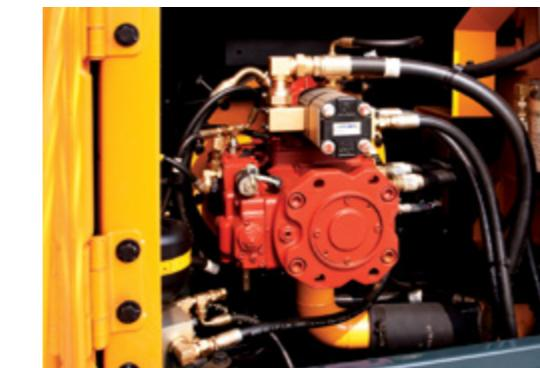
Para lograr un precisión óptima, Hyundai rediseñó el sistema hidráulico para ofrecer al operador un tacto de alta calidad y gobernabilidad mejorada. El control de flujo de la bomba mejorado reduce el flujo cuando los controles no se usan para minimizar el consumo de combustible. Las válvulas de bobina mejoradas en las válvulas de control fueron diseñadas para proveer un flujo más preciso en cada función con menos esfuerzo.
