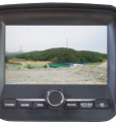
El nuevo y avanzado panel con pantalla LCD a color de 7 pulgadas de ancho e interruptor de palanca permite que el operador seleccione sus preferencias personales en la máquina. Selección de modo de potencia y funcionamiento, autodiagnósticos, cámara retrovisora opcional, listas de control de mantenimiento, seguridad en el arranque de la máquina, y funciones de video están integrados en el panel para que la máquina sea más versátil y el operador más productivo.
