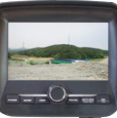
La nueva avanzada consola con una pantalla color de 7 pulgadas de ancho y el interruptor de palanca permite al operador seleccionar sus preferencias personales en la máquina. Selección del modo potencia y trabajo, auto diagnóstico, cámara retrovisora opcional, listas de control de mantenimiento, seguridad en el arranque de la máquina, y funciones de video fueron integradas en el clúster para hacer más versátil a la máquina y más productivo al operador.
